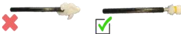
รูปที่ 4.13 การทำ point electrode ที่เหมาะสม
