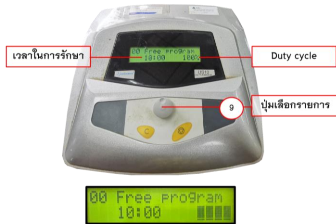
ภาพที่ 32 แสดงการปรับค่าการรักษาแบบต่อเนื่องหรือแบบช่วง (Continuous/Pulsed mode) และการตั้งค่าเวลาในการรักษา
