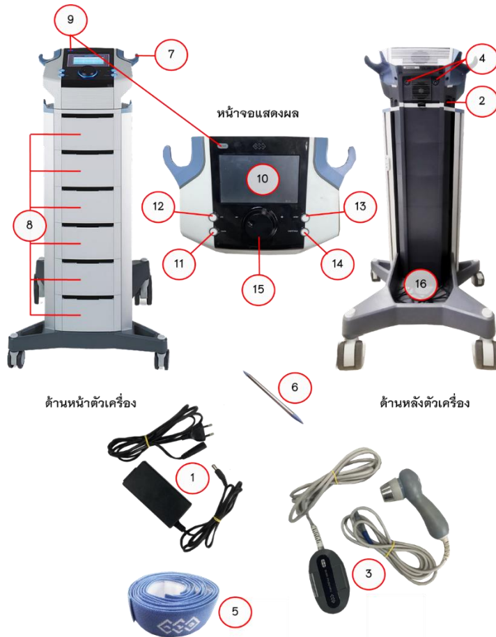
ภาพที่ 37 แสดงส่วนประกอบของเครื่อง และปุ่มต่าง ๆ ของเครื่องผลิตคลื่นเหนือเสียง ยี่ห้อ BTL รุ่น BTL 4000 Premium แบบ 2 ความถี่
