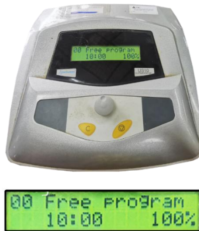
ภาพที่ 31 แสดงหน้าจอหลัก เครื่องผลิตคลื่นเหนือเสียง ยี่ห้อ Cosmogamma รุ่น US 10 แบบ 1 ความถี่
