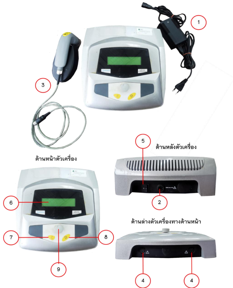
ภาพที่ 30 แสดงส่วนประกอบของเครื่อง และปุ่มต่าง ๆ ของเครื่องผลิตคลื่นเหนือเสียง ยี่ห้อ Cosmogamma รุ่น US 10 แบบ 1 ความถี่
