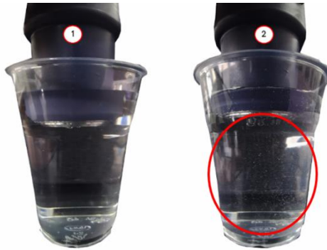
ภาพที่ 8 แสดงการทดสอบปล่อยคลื่นของหัวส่งคลื่น สังเกตได้ว่าแก้วใบที่ 2 มีการเคลื่อนไหวของน้ำที่เกิดจากแรงดันของคลื่นน้ำบริเวณแนวกลางของหัวส่งคลื่น (วงกลมสีแดง) (ภาพโดย พลากร อุดมกิจปรกรณ์)
