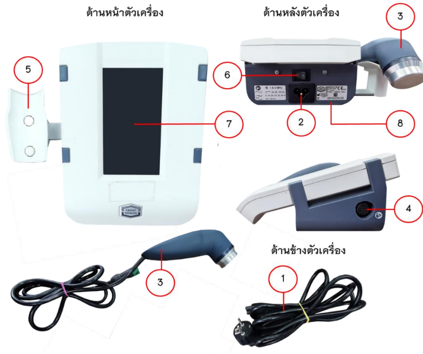
ภาพที่ 17 แสดงส่วนประกอบของเครื่อง และปุ่มต่าง ๆ ของเครื่องผลิตคลื่นเหนือเสียง ยี่ห้อ Enraf-Nonius รุ่น Sonopuls 190 New แบบ 2 ความถี่
