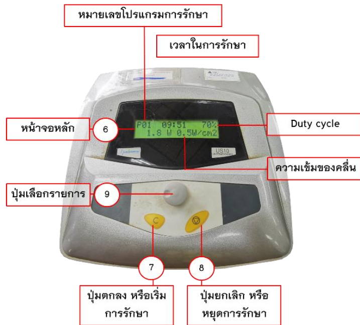
ภาพที่ 33 แสดงหน้าจอการเริ่มต้นการทำงาน และการปรับค่าความเข้มของเครื่องผลิตคลื่นเหนือเสียง ยี่ห้อ Cosmogamma รุ่น US 10 แบบ 1 ความถี่
