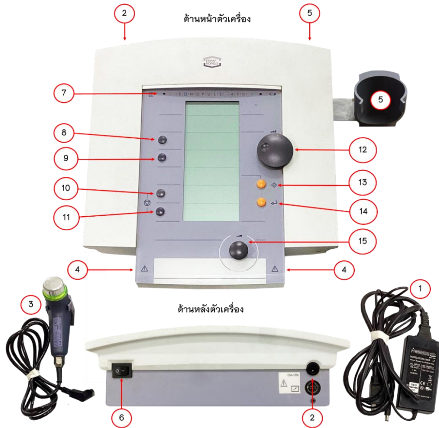
ภาพที่ 14 แสดงส่วนประกอบของเครื่อง และปั๊มต่าง ๆ ของเครื่องผลิตคลื่นเหนือเสียง ยี่ห้อ Enraf-Nonius รุ่น Sonopuls 490 แบบ 2 ความถี่
