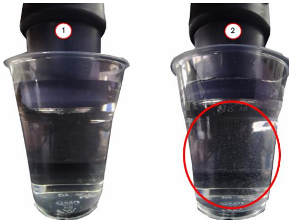
ภาพที่ 8 แสดงการทดสอบปล่อยคลื่นของหัวส่งคลื่น สังเกตได้ว่าแก้วใบที่ 2 มีการเคลื่อนไหวของน้ำที่เกิดจากแรงดันของคลื่นน้ำบริเวณแนวกลางของหัวส่งคลื่น (วงกลมสีแดง)
