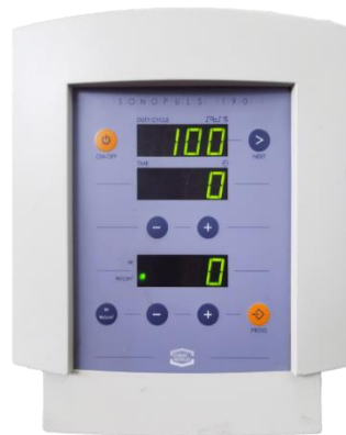
ภาพที่ 29 แสดงหน้าจอหลัก เครื่องผลิตคลื่นเหนือเสียงยี่ห้อ Enraf-Nonius รุ่น Sonopuls 190 แบบ 1 ความถี่
