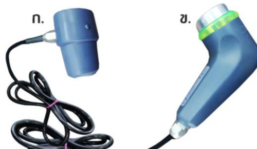
ภาพที่ 43 แสดงลักษณะของหัวส่งคลื่น ก. แบบถ้วย และ ข. แบบมีด้ามจับยาว (ภาพโดย พลากร อุดมกิจปรกรณ์)
